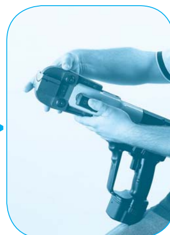
Bloccare la pinza chiudendo il pistone di fermo.
